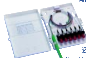
这些模块是为了用于 USOH™ 墙板系统内部而设计的，分成 25x50mm 和 50x50mm 平直正面型和 50x50mm 斜面型，保证了正确的弯曲半径。可以从正面迅速组装墙板，墙板可以容纳 ST、SC、MT-RJ 和 FDDI 光纤适配器。
